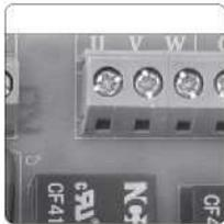
**W - V - U - Hilos del Motor**
